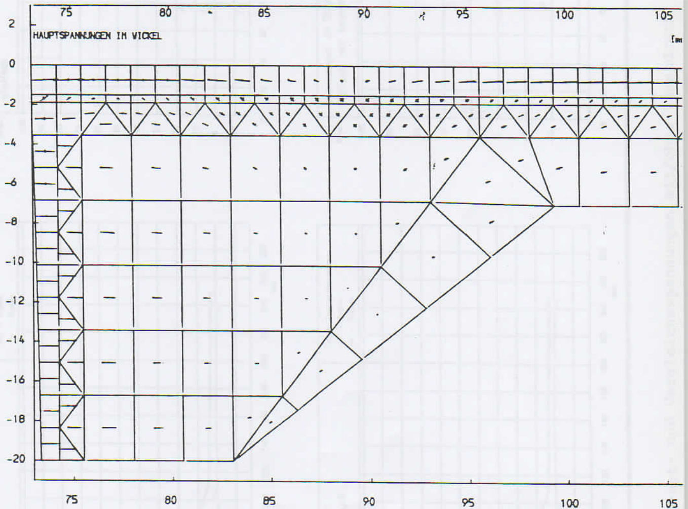
Bild 22: Hauptspannungen im Fußbereich der Rotorscheibe
